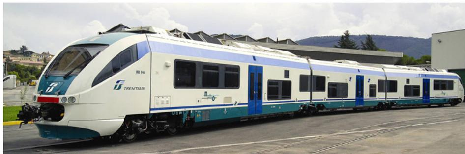
in versione diesel ed elettrica, destinato al trasporto dei pendolari, è composto da tre carrozze capaci di 122 posti a sedere di seconda classe e 24 di prima classe, più 200 in piedi. La versione elettrica può raggiungere i 160 km orari, quella diesel i 130. Disponibile un'area per disabili, indicazioni interne anche in braille, è possibile montare attrezzature per il trasporto di biciclette. Il Minuetto è stato il primo treno italiano a essere dotato di videosorveglianza.
